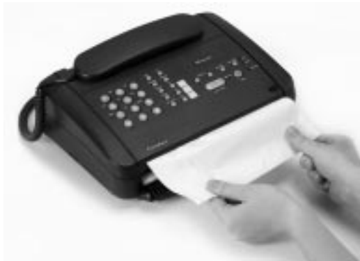
Afbeelding 14: Vastgelopen papier verwijderen.
